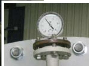
Previo al comienzo de la fabricación se sometieron muestras de tubería, portabridas y uniones a pruebas de presión a 6,5 Bar durante 24 horas.
